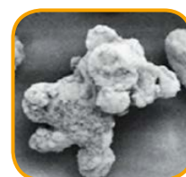
A granulátum scanning mikroszkópos képe
